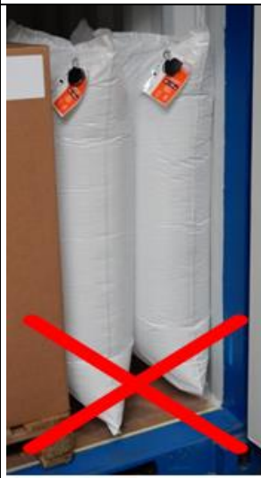
Gebruik buffermateriaal om scherpe randen te vermijden
