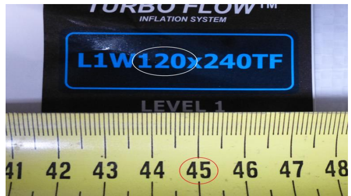
120cm brede stuwzak voor ruimte tot max. 45cm
