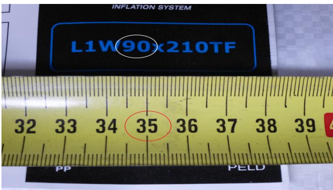
90cm brede stuwzak voor ruimte tot max. 35cm
