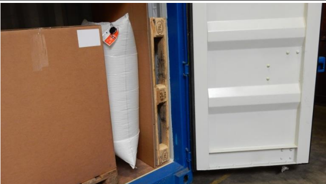
Als de ruimte te groot is, buffermateriaal gebruiken
