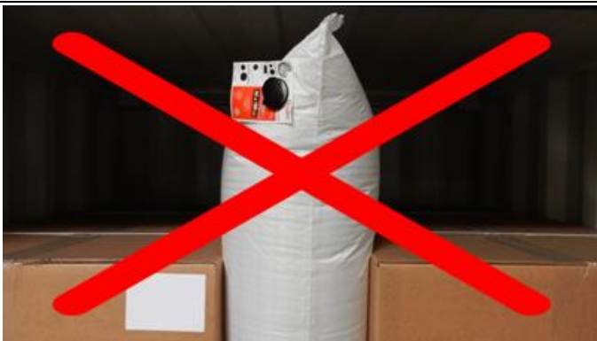
Plaats de stuwzak verticaal, niet hoger dan de lading
