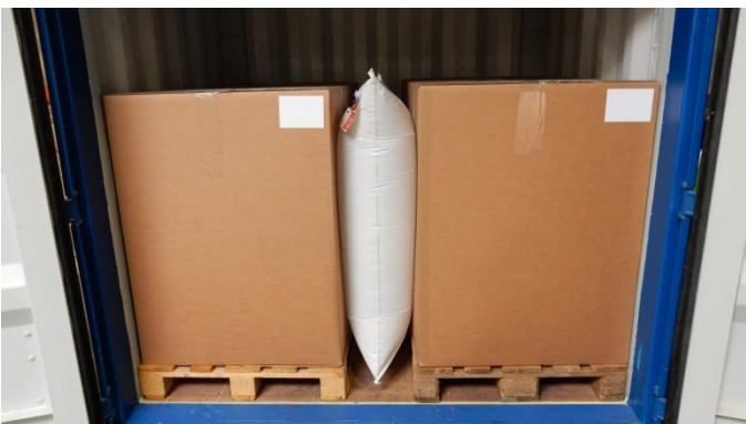
De stuwzak moet minimaal 50% van het oppervlak van de lading bedekken
