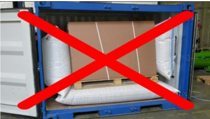
Gebruik stuwzakken niet om lading te recht te zetten
