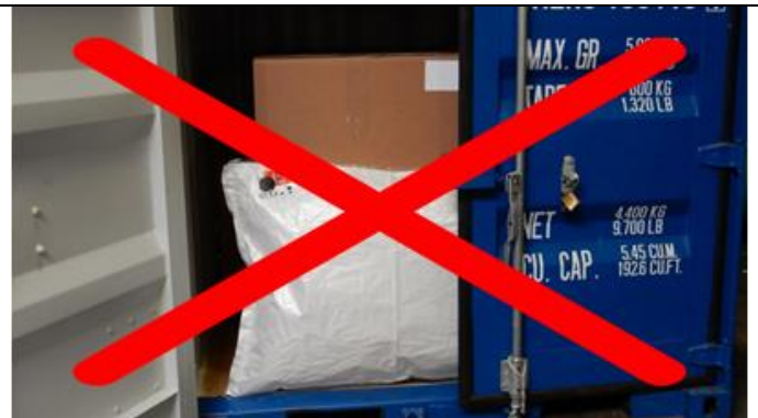
Plaats geen stuwzakken tussen lading en deur
