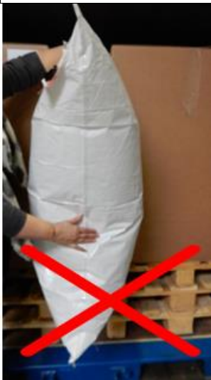
Gebruik stuwzakken nooit horizontaal
