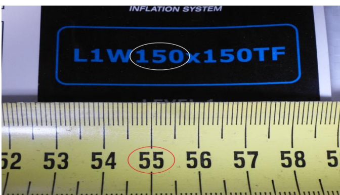
150cm brede stuwzak voor ruimte tot max. 55cm
