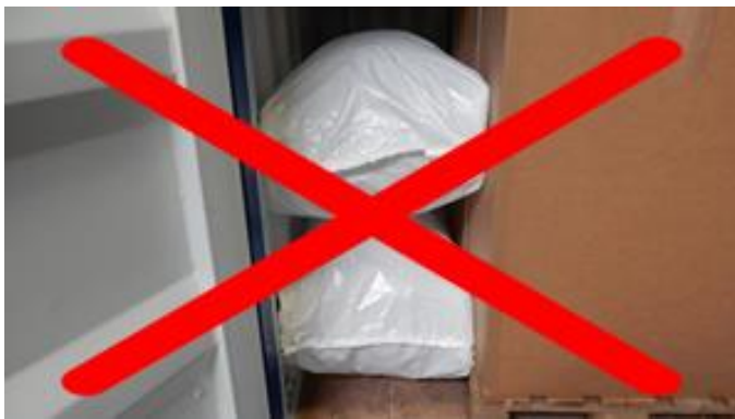
Gebruik stuwzakken nooit horizontaal
